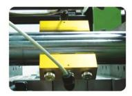
左: 2 SML-ME感測儀在歌林柱上進行彎曲補償測量。
